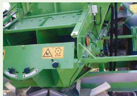
Hydraulicky sklopná násypka pre zníženie strát pri presunoch.
