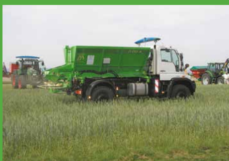
Rozmetacia nadstavba na podvozku MB-Unimog.
