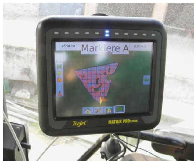
Rozmetanie na základe úrodových máp pomocou GPS systému „Matrix Pro“
