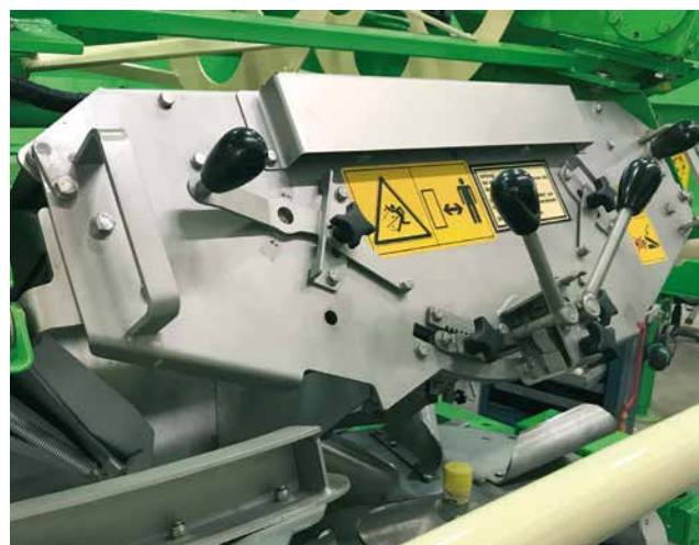
Systém automatického vypínania sekcií (príplatková výbava)
