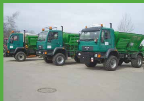
Rozmetacie zariadenie v podniku služieb na podvozku MAN – 14t.
