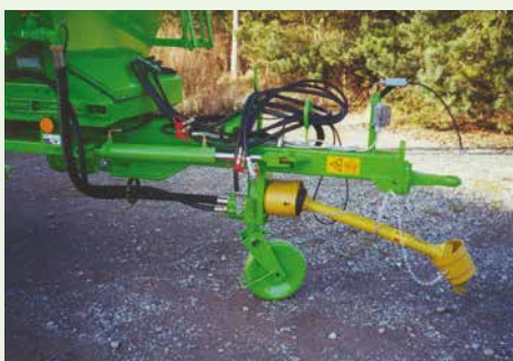
Automaticky riadené ojo, pre dokonalé kopírovanie stopy traktora.
