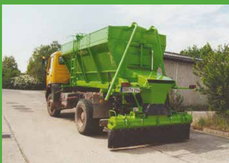
Rozmetacia nadstavba pre stabilizáciu pôdy.
