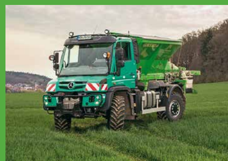
Rozmetacia nadstavba na podvozku MB-Unimog.
