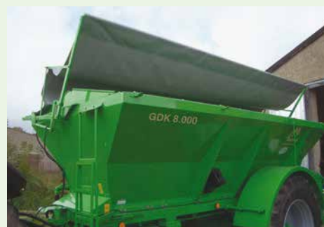
Hydraulicky sklopná plachta.
