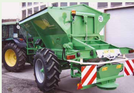
Jednokotúčový systém pre potreby zimnej údržby.
