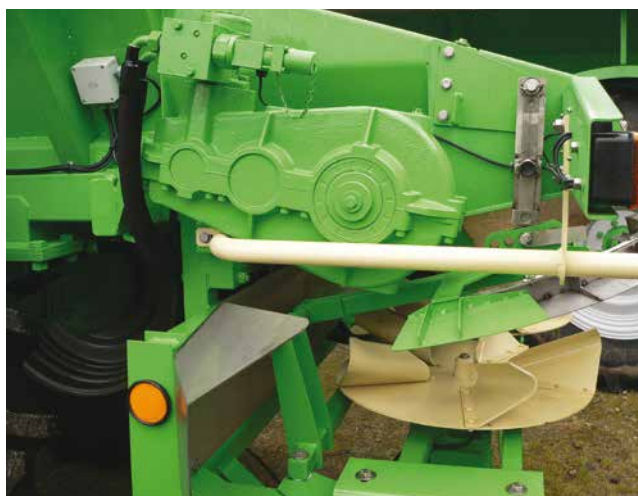
Prevodovka pre pohon kovového dopravníka. V kombinácii s proporcionálnym ventilom sa nastavuje rýchlosť posunu dopravníka elektronicky.
