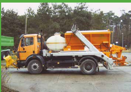
Zariadenie na aplikáciu soľného roztoku pre údržbu ciest.
