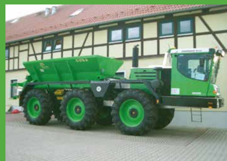
Rozmetacia nadstavba pre samochod Dammann Trac DT 2600 H.
