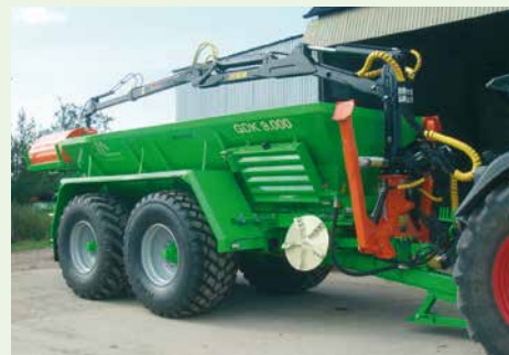
GDK s Boogie-nápravou a hydraulickou rukou.
